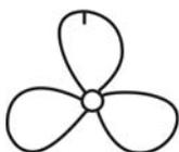
Для определения реальной скорости вентилятора мы наносим метку на одну из лопостей и повторяем тест снова.
